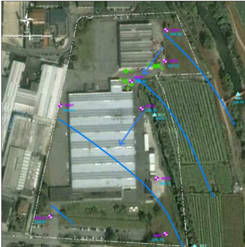
Figura 21 - Ricostruzione andamento piezometrico della falda piano della caratterizzazione Timken Italia 16 luglio 2012
