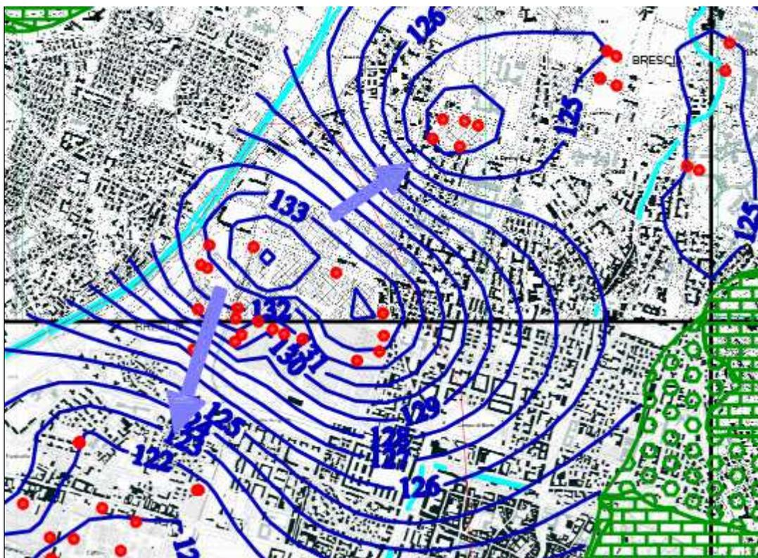
**Figura 3** – Stralcio ricostruzione piezometrica (settembre 2014)
