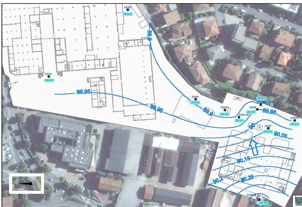
**Figura 19** – Ricostruzione piezometria statica Sito Federal-Mogul (Giugno 2005)
