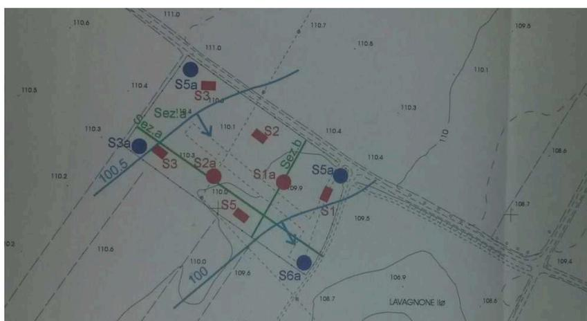
**Figura 18** - Andamento piezometrico della falda
